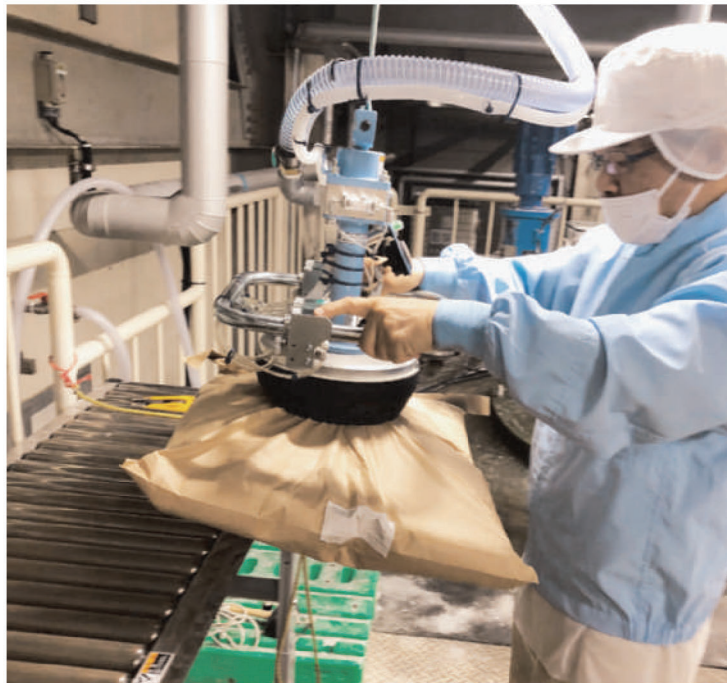
重筋作業はハンドクレーンを導入し、ベテラン作業者の身体的な負担を軽減
